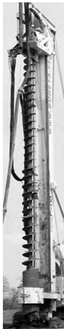
Obr. 5.20 Ukázka šnekového vrtáku.
