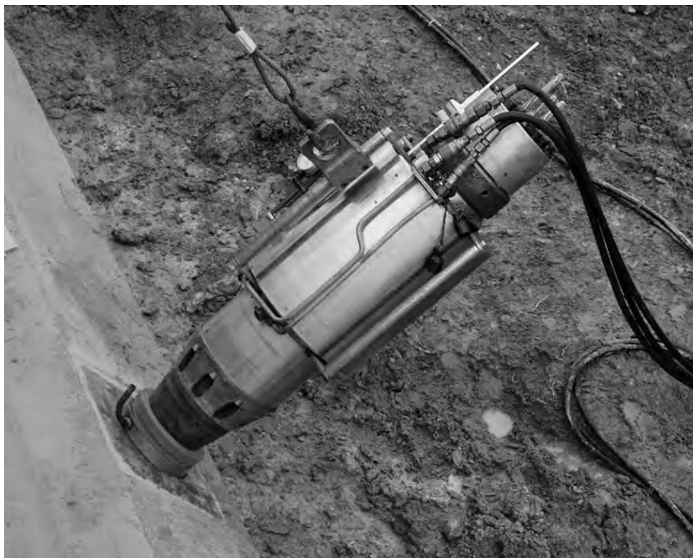
Obr. 5.71 Hydraulické upínací zařízení pro kabelové kotvy.
