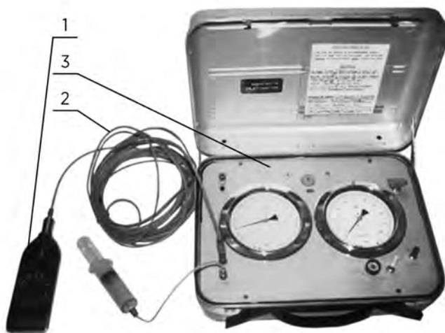
Obr. 4.27 Komplet zařízení pro provedení zkoušky. 1 – sonda, 2 – přenosný kabel, 3 – měřicí přístroj.
