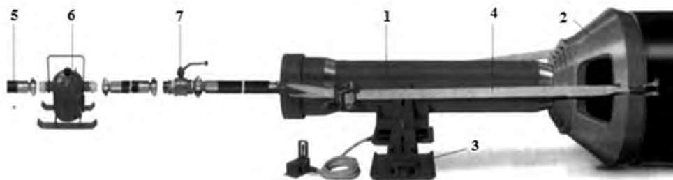
Obr. 4.129 Zařízení pro vodorovné beranění s otevřeným čelem (Tracto-Technik, Německo).
