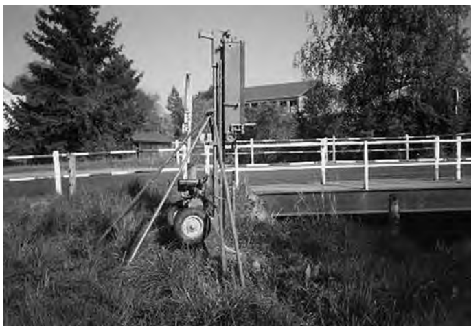
Obr. 4.39 Ukázka další konstrukce soupravy pro těžkou dynamickou penetraci.
