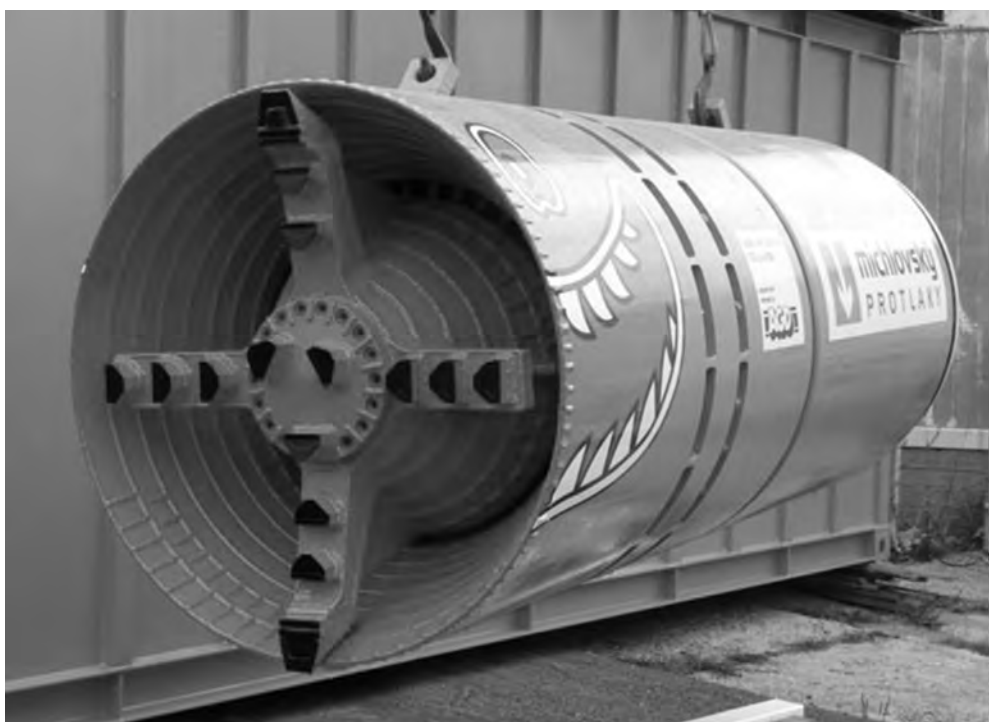
Obr. 5.142 Ukázka plnoprofilové vrtné hlavy – mikrotunelovacího štítu.
