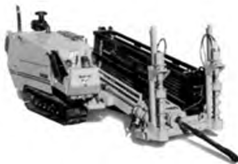
Obr. 5.157 Vrtná souprava typu Vermeer pro horizontální řízené vrtání a používané průměry pilotního a následného rozšiřovacího vrtu.
