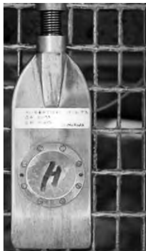
Obr. 4.26 Ocelová sonda s membránou.
