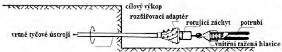
Obr. 5.156 Schematické znázornění rozšiřovací hlavy ve spojení se zatahovacím potrubím.
