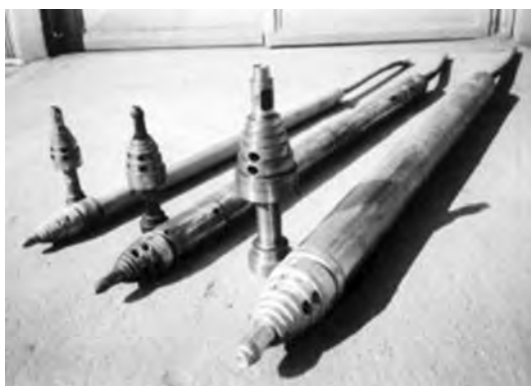
Obr. 5.123 Ukázka propichovacích kladiv typu Grundomat.
