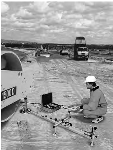
Obr. 4.42 Ukázka provádění zatěžovací zkoušky deskou na povrchu.
