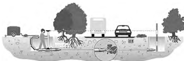
Obr. 5.121 Schematické znázornění propichování zeminy zařízením Grundomat.
