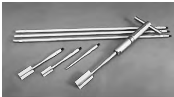
Obr. 4.33 Ukázka konstrukce vrtulek, používaných k terénní vrtulkové zkoušce.
