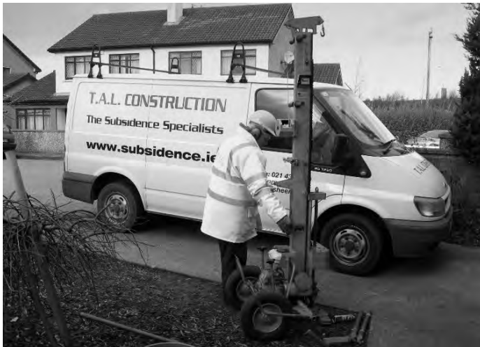
Obr. 4.38 Ukázka soupravy pro těžkou dynamickou penetraci.
