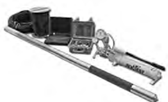
Obr. 4.25 Ukázka sestavy pružného dilatometru.
