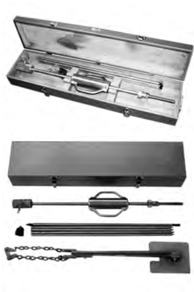
Obr. 4.35 Zařízení pro DPL.
