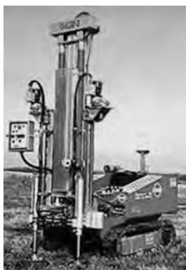
Obr. 4.29 Souprava pro zkoušku plochým lisem (dosah 20 m).
