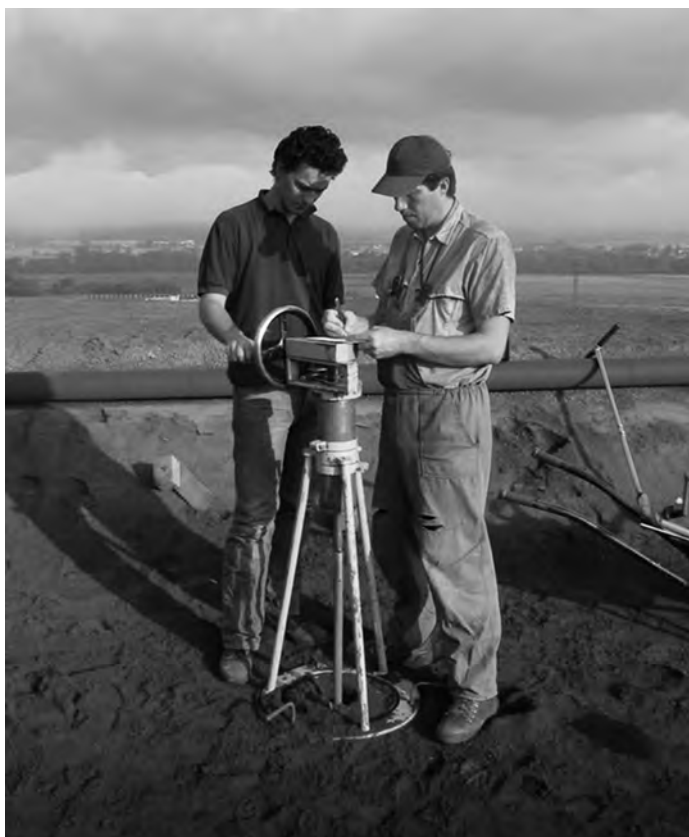
Obr. 4.34 Variantní provádění terénní vrtulkové zkoušky.
