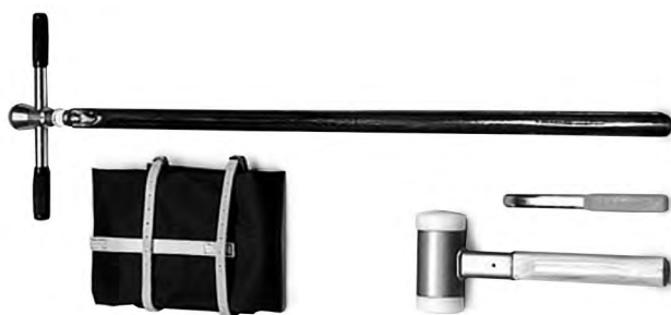
Obr. 4.14 Vybavení pro zarážení sondy.
