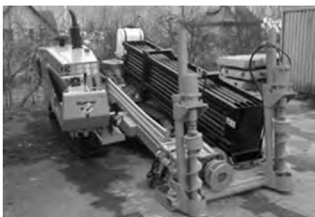
Obr. 5.151 Vrtná souprava pro usměrněné horizontální vrtání s automatickým systémem podávání vrtných trubek.
