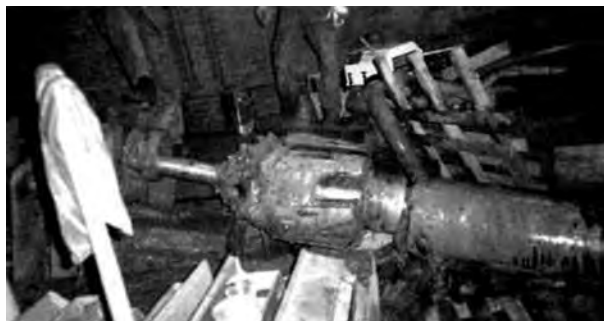
Obr. 5.152 Kuzelová rozšiřovací hlava (Cone Compaction Backreamer) určená do zemin.
