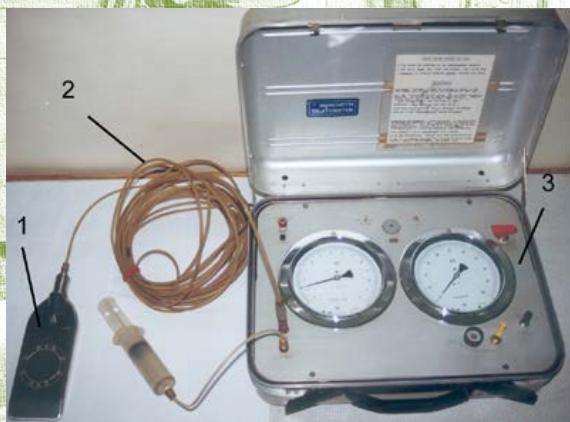
Komplet zařízení pro provedení zkoušky (1 – sonda, 2 – přenosný kabel, 3 – měřicí přístroj)
