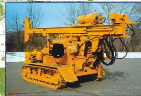
Vrtná souprava Acker MP-8 provedení na pásovém podvozku
