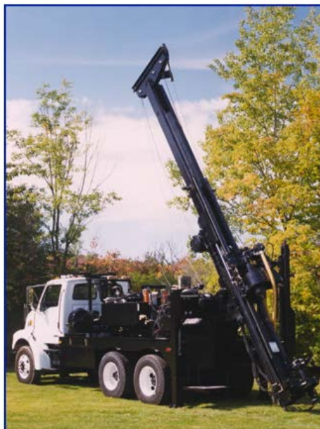
1 – lafeta, 2 - rotační hlava, 3 – svěra vrtných trubek, 4 - ovládací a kontrolní panel, 5 - pohonný agregát
