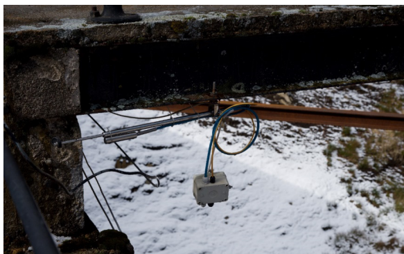
Abbildung 7-4: In-situ Installation des Dilatometers und Rissmessers mit Wärmeübertragungsfühler für die Messung der Materialausdehnung am Stausee Jezeří (über den Sperrhängen des Steinbruchs ČSA). Foto: VŠB – Technische Universität Ostrava.
