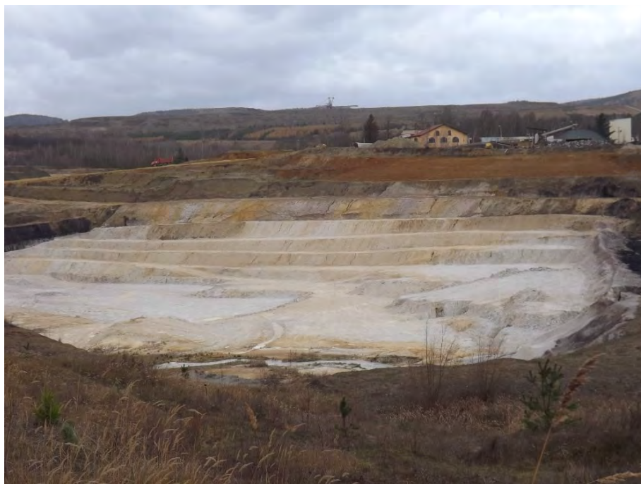
Obr.1 Příklad povrchového dobývání kaolínu lávkováním
